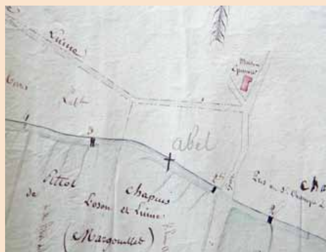
Extrait du plan : les N° 2, 2bis, 3, 4 représentent l'emplacement des vannes ou barrages pour l'irrigation de la plaine.
